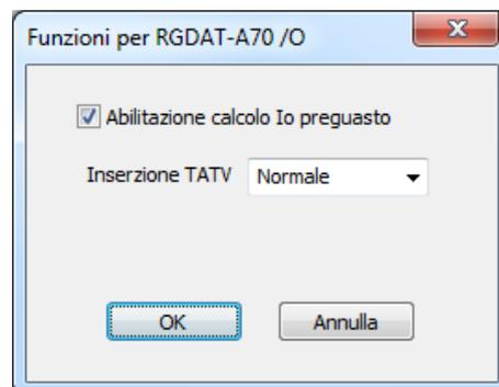
Attraverso tale finestra di dialogo è possibile abilitare il calcolo della  $I_o$  in assenza di guasto in linea per poi sottrarre tale valore quando si verifica una situazione di guasto, ed è inoltre impostabile il senso di inserzione dei TATV (Normale o Invertita).
