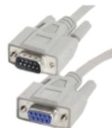
Per la connessione tra PC e RGDAT è necessario utilizzare un cavo seriale "diritto", del tipo di quello mostrato nella figura a lato.
