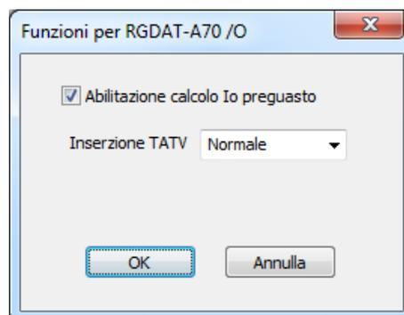
Attraverso tale finestra di dialogo è possibile abilitare il calcolo della  $I_0$  in assenza di guasto in linea per poi sottrarre tale valore quando si verifica una situazione di guasto, ed è inoltre impostabile il senso di inserzione dei TATV (Normale o Invertita).
